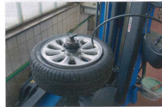
Die Erstbefüllung des Reifens sollte automatisch erfolgen, damit der Mitarbeiter einen Sicherheitsabstand einhalten kann.
