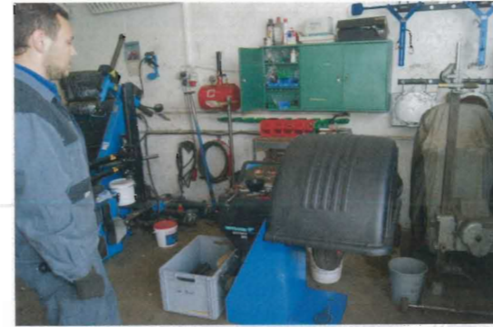
Das Wuchten von Reifen darf zum Schutz vor sich lösenden Wuchtgewichten nur unter einer Schutzhaube erfolgen.
