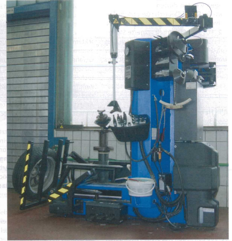
Reifenmontiermaschinen sind im Betrieb so aufzustellen, dass um sie herum genug Platz zum Arbeiten ist.
